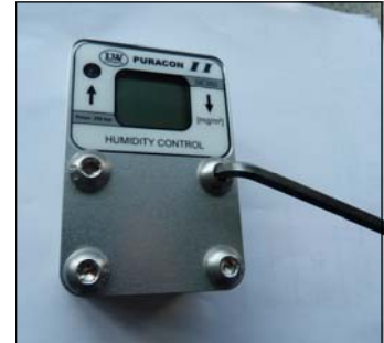
Abb. 1 - Deckelschrauben lösen, Schrauben nicht entnehmen
