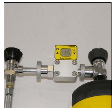
Puracon Mobile an die Flasche anschließen
