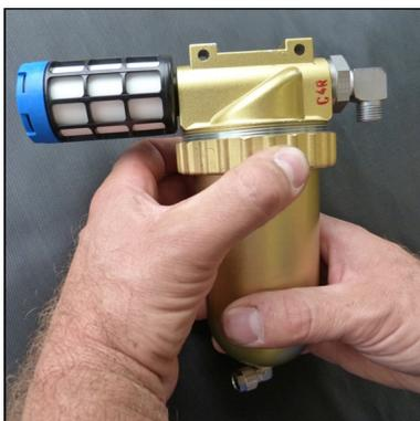
Abb. 1 - Gewinding lösen
