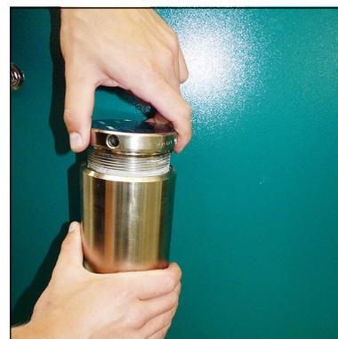
Abb. 1 - Filterdeckel öffnen
