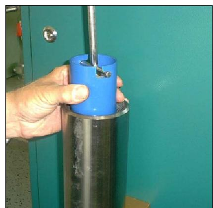
Abb. 3 - Filterpatrone aus dem Gehäuse ziehen
