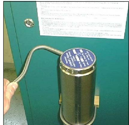
Abb. 1 - Abschrauben des Filtergehäuse-Deckels
