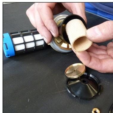
Abb. 2 - Sinterfilter wechseln
