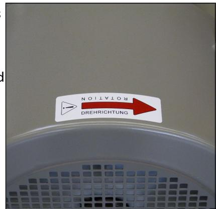
Abb. 1 - Drehrichtungspfeil (Motor)
