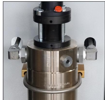
Abb. 1 - Rohrleitungsverraubungen und Muttern lösen
