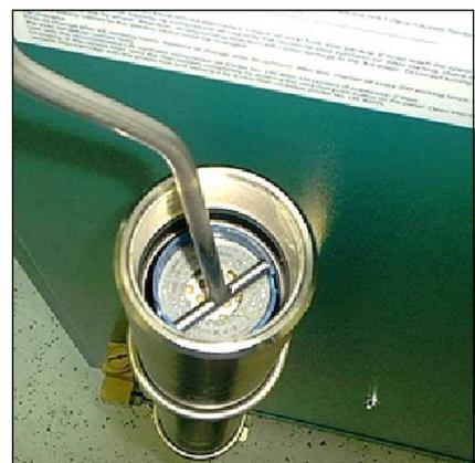
Abb. 2 - T-Stück Ende des Filter-Schlüssels in die Aussparungen legen
