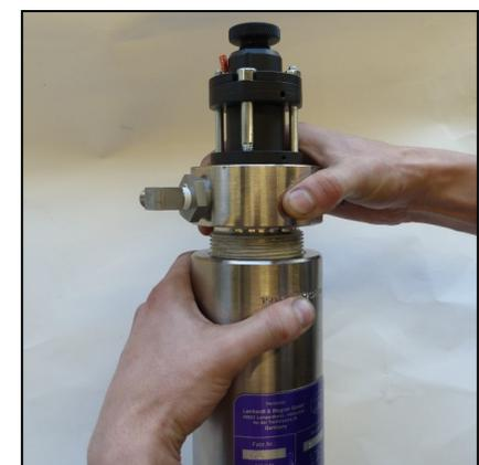
Abb. 3 - Filterdeckel öffnen
