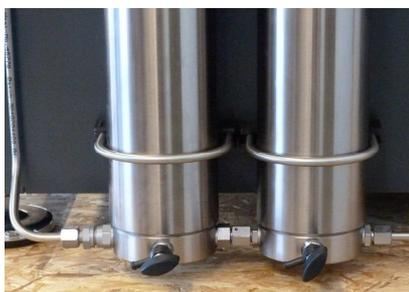
Abb. 3 - Rohrleitungsverschraubungen und Muttern lösen
