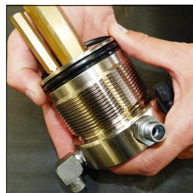
Abb. 4 - O-Ring und Stützring wechseln
