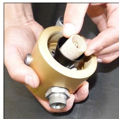
Abb. 2 - Sinterfilter wechseln
