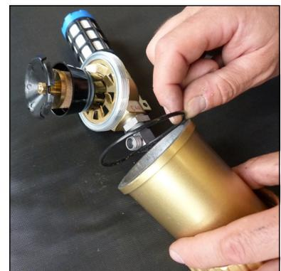
Abb. 3 - O-Ring wechseln
