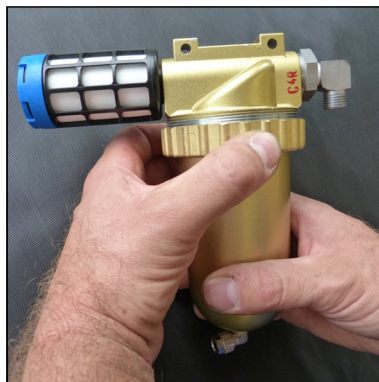
Fig. 1 - Loosen ring nut
