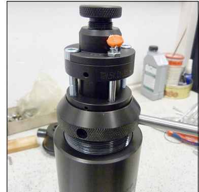
Abb. 1 - Filterdeckel abdrehen/ eindreuen
