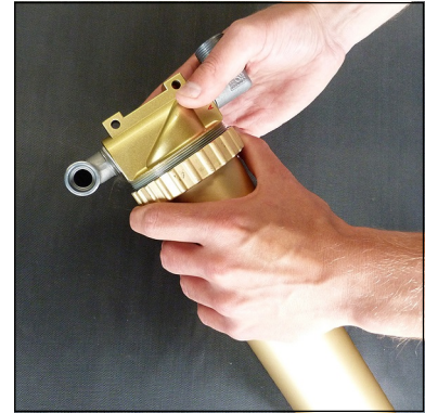
Abb. 1 - Gewinding öffnen und Oberteil abnehmen
