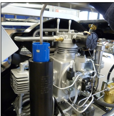
Abb. 2 - Filterpatrone mit Filterschlüssel entnehmen
