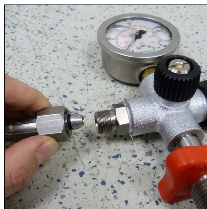
Abb. 2 - O-Ring am Füllschlauch
