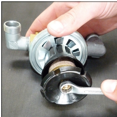
Abb. 2 - Mutter am Oberteil lösen
