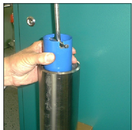
Abb. 3 - Filterpatrone aus dem Gehäuse ziehen
