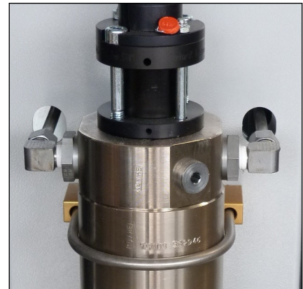
Abb. 1 - Rohrleitungsverschraubungen und Muttern lösen
