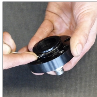
Abb. 4 - O-Ring wechseln (Deckel Kondensat-Stopp-Ventil)
