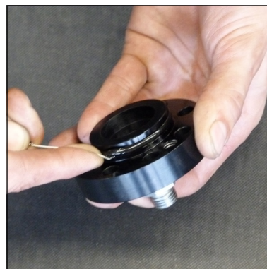
Abb. 4 - O-Ring wechseln (Deckel Kondensat-Stopp-Ventil)
