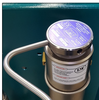
Abb. 2 - Abschrauben des Filtergehäuse-Deckels
