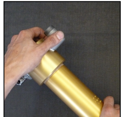
Abb. 1 - Oberteil abschrauben und abnehmen
