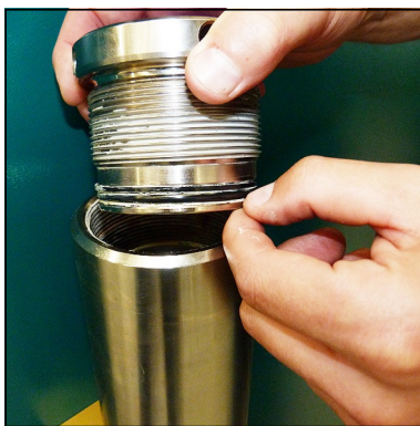
Abb. 2 - O-Ring und Stützring wechseln
