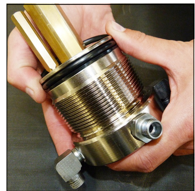
Abb. 4 - O-Ring und Stützring wechseln
