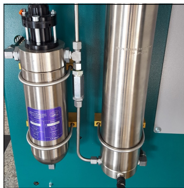
Abb. 3 - Rohrleitungsverschraubungen und Muttern lösen
