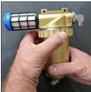
Fig. 1 - Loosen ring nut
