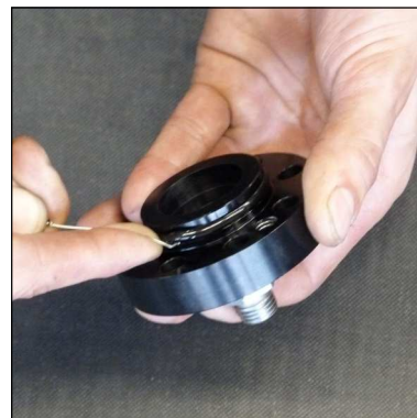
Abb. 4 - O-Ring wechseln (Deckel Kondensat-Stopp-Ventil)
