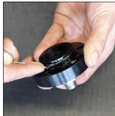
Abb. 4 - O-Ring wechseln (Deckel Kondensat-Stopp-Ventil)
