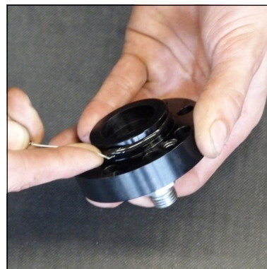
Abb. 4 - O-Ring wechseln (Deckel Kondensat-Stopp-Ventil)
