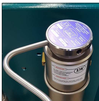
Abb. 2 - Abschrauben des Filtergehäuse-Deckels
