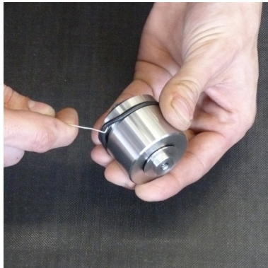
Abb. 4 - O-Ring wechseln am Kondensat-Stopp-Ventil
