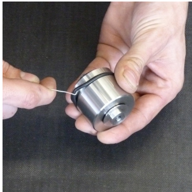
Abb. 4 - O-Ring wechseln am Kondensat-Stopp-Ventil
