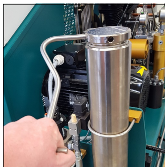
Abb. 2 - Abschrauben des Filtergehäuse-Deckels
