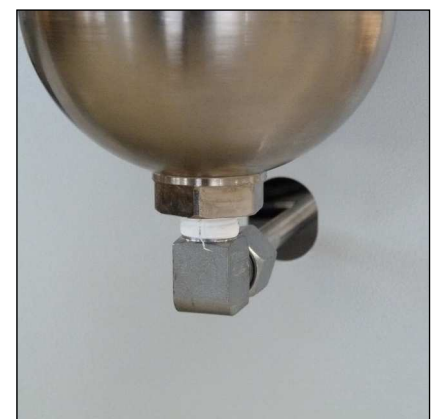
Abb. 2 - Rohrleitungen und Muttern lösen
