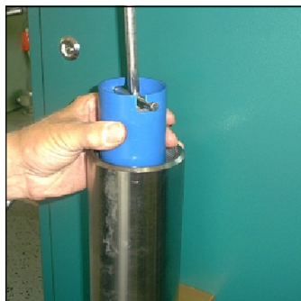
Abb. 4 - Filterpatrone aus dem Gehäuse entnehmen
