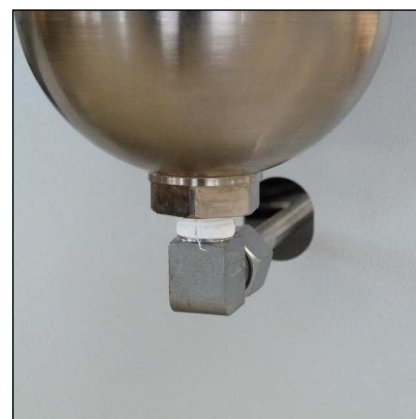
Abb. 2 - Rohrleitungen und Muttern lösen
