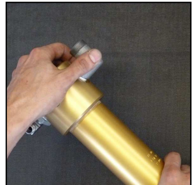
Abb. 1 - Oberteil abschrauben und abnehmen
