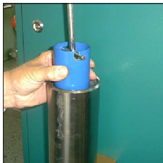
Abb. 4 - Filterpatrone aus dem Gehäuse entnehmen
