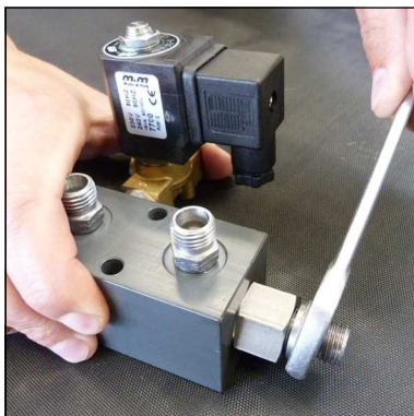
Abb. 1 - Gerade Verschraubung lösen
