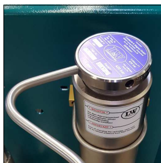
Abb. 2 - Abschrauben des Filtergehäuse-Deckels
