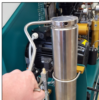
Abb. 2 - Abschrauben des Filtergehäuse-Deckels
