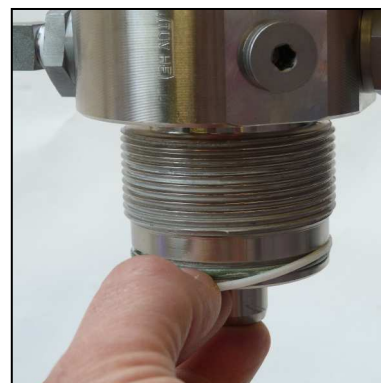
Abb. 1 - O-Ring und Stützring wechseln
