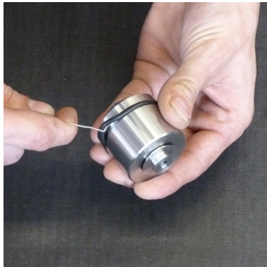
Abb. 4 - O-Ring wechseln am Kondensat-Stopp-Ventil
