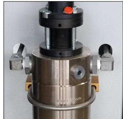
Abb. 1 - Rohrleitungen und Muttern lösen
