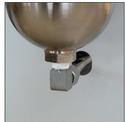
Abb. 2 - Rohrleitungen und Muttern lösen
