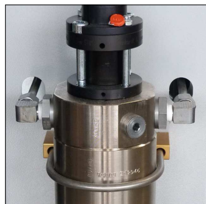
Abb. 1 - Rohrleitungen und Muttern lösen
