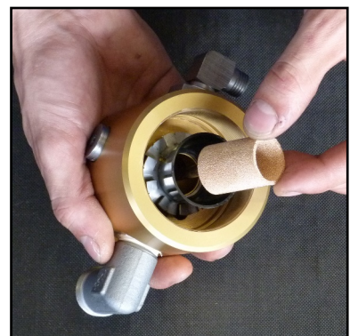
Abb. 3 - Sinterfilter wechseln
