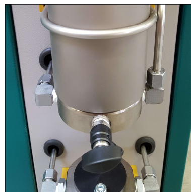
Abb. 3 - Rohrleitungsverschraubungen und Muttern lösen
