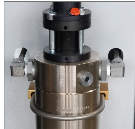
Abb. 1 - Rohrleitungen und Muttern lösen
