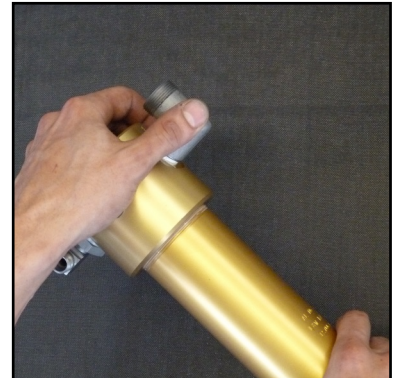
Abb. 1 - Oberteil abschrauben und abnehmen
