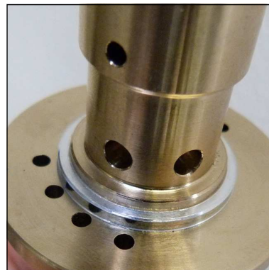
Abb. 4 - Auf korrekte Einbauposition des oberen Ventildichtrings achten
