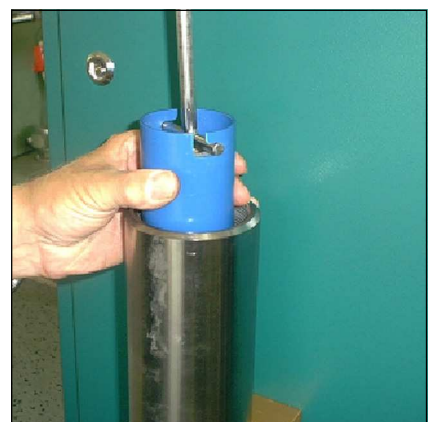
Abb. 3 - Filterpatrone aus dem Gehäuse ziehen
