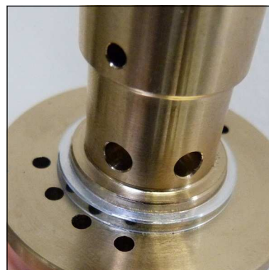
Abb. 4 - Auf korrekte Einbauposition des oberen Ventildichtrings achten
