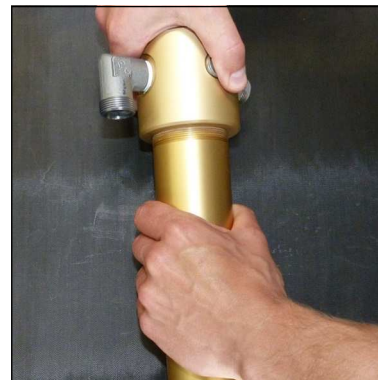
Abb. 1 - Oberteil abschrauben und abnehmen
