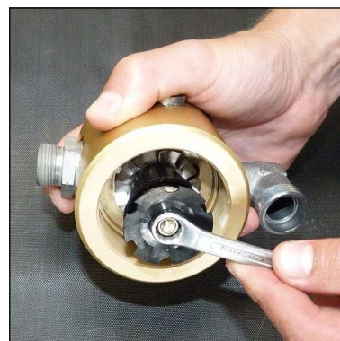
Abb. 2 - Mutter am Oberteil lösen
