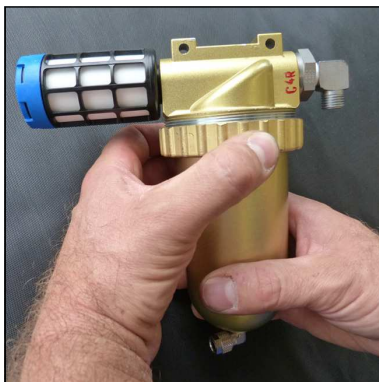
Fig. 1 - Loosen ring nut
