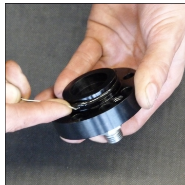
Abb. 4 - O-Ring wechseln (Deckel Kondensat-Stopp-Ventil)
