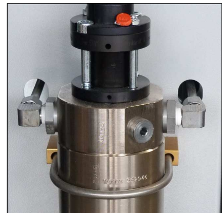
Abb. 1 - Rohrleitungsverschraubungen und Muttern lösen
