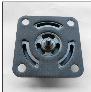
Abb. 4 - Auf korrekte Platzierung der Papierdichtung achten!
