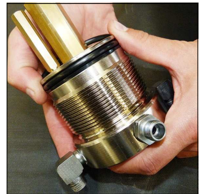
Abb. 4 - O-Ring und Stützring wechseln
