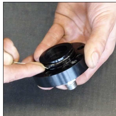
Abb. 4 - O-Ring wechseln (Deckel Kondensat-Stopp-Ventil)
