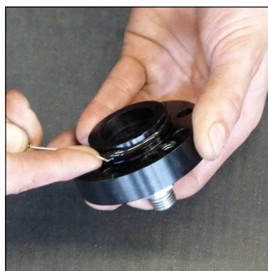
Abb. 4 - O-Ring wechseln (Deckel Kondensat-Stopp-Ventil)
