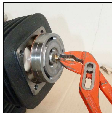
Abb. 2 - Saug- / Druckventil herausziehen
