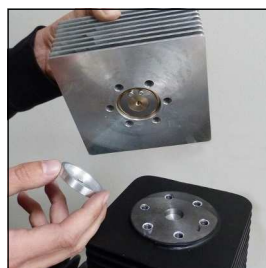
Abb. 2 Untere Ventildichtung entfernen
