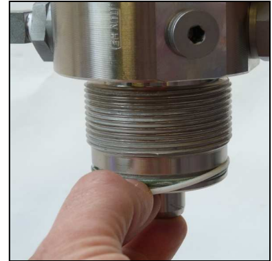
Abb. 2 - O-Ring und Stützring wechseln
