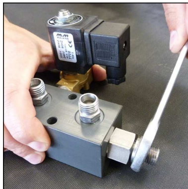
Abb. 2 - Gerade Verschraubung lösen
