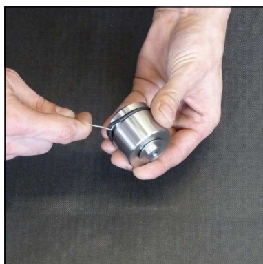
Abb. 3 - O-Ring wechseln (Kondensat-Stopp-Ventil)
