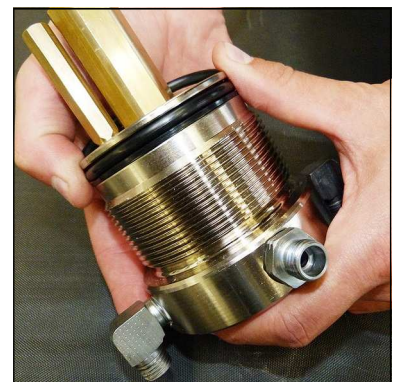
Abb. 4 - O-Ring und Stützring wechseln
