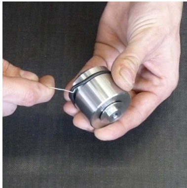
Abb. 4 - O-Ring wechseln am Kondensat-Stopp-Ventil
