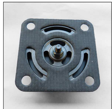
Abb. 4 - Auf korrekte Platzierung der Papierdichtung achten!
