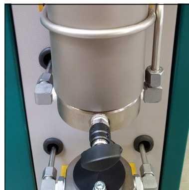
Abb. 3 - Rohrleitungsverschraubungen und Muttern lösen
