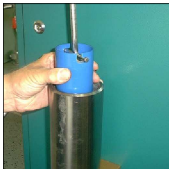
Abb. 4 - Filterpatrone aus dem Gehäuse entnehmen
