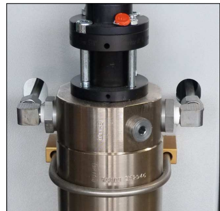
Abb. 1 - Rohrleitungsverschraubungen und Muttern lösen
