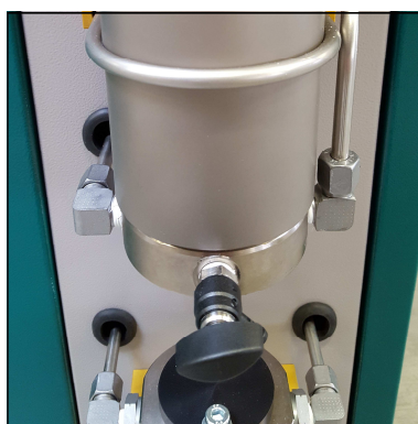
Abb. 3 - Rohrleitungsverschraubungen und Muttern lösen
