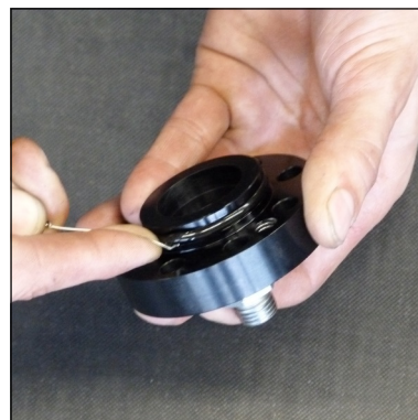
Abb. 4 - O-Ring wechseln (Deckel Kondensat-Stopp-Ventil)
