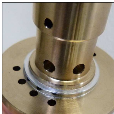
Abb. 4 - Auf korrekte Einbauposition des oberen Ventildichtrings achten
