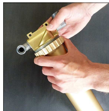
Abb. 1 - Gewinding öffnen und Oberteil abnehmen
