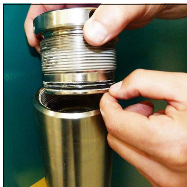
Abb. 2 - O-Ring und Stützring wechseln
