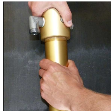
Abb. 1 - Oberteil abschrauben und abnehmen
