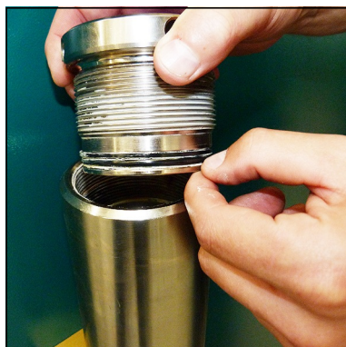
Abb. 2 - O-Ring und Stützring wechseln
