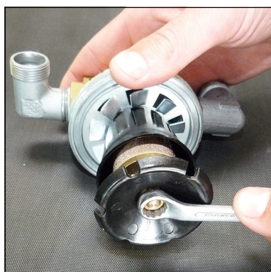
Abb. 2 - Mutter am Oberteil lösen
