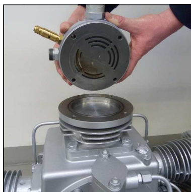
Abb. 3 - Einbauposition der Ventilplatte mit Ventilkopf
