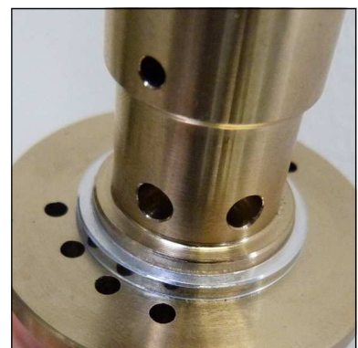
Abb. 5 - Auf korrekte Einbauposition des oberen Ventildichtrings achten
