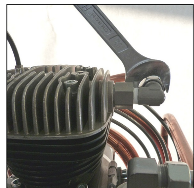
Abb. 6 - Rohrleitungsverschraubung anschließen und anziehen
