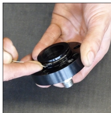
Abb. 4 - O-Ring wechseln (Deckel Kondensat-Stopp-Ventil)
