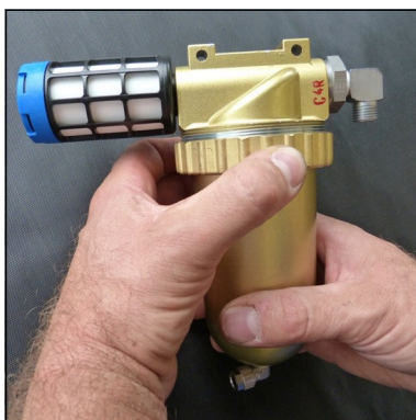
Fig. 1 - Loosen ring nut
