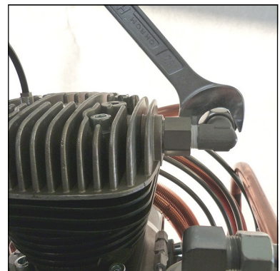
Abb. 6 - Rohrleitungsverschraubung anschließen und anziehen
