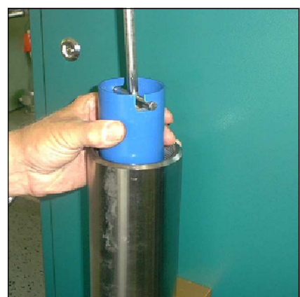
Abb. 3 - Filterpatrone aus dem Gehäuse ziehen
