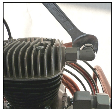
Abb. 6 - Rohrleitungsverschraubung anschließen und anziehen
