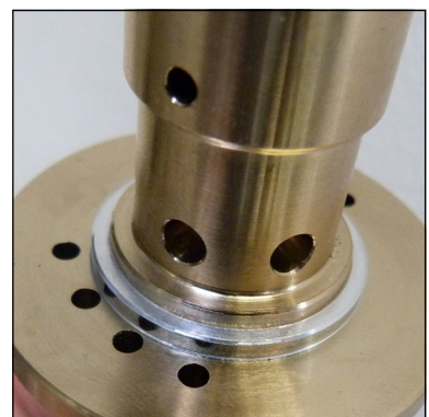
Abb. 5 - Auf korrekte Einbauposition des oberen Ventildichtrings achten
