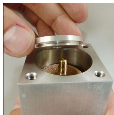
Abb. 5 - Filterscheibe und Unterlegscheibe aufsetzen
