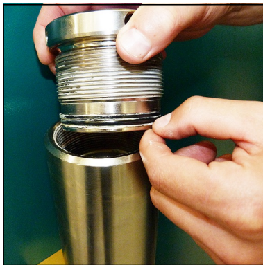
Abb. 2 - O-Ring und Stützring wechseln
