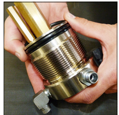
Abb. 4 - O-Ring und Stützring wechseln
