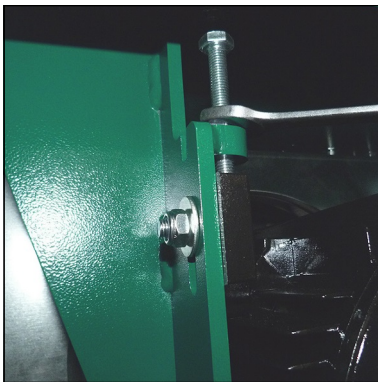
Fig. 2 - Loosen counter nut
