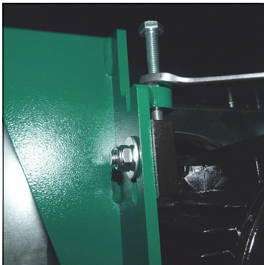
Fig. 2 - Loosen counter nut
