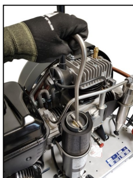
Abb. 3 Filterpatrone mittels Filterschlüssel herausziehen und neue Filterpatrone einsetzen
