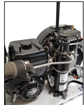
Abb. 1 Filtergehäusedeckel mit Filterschlüssel öffnen
