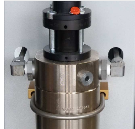
Abb. 1 - Rohrleitungsverraubungen und Muttern lösen
