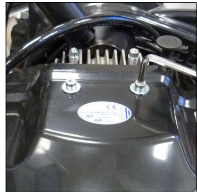
Abb. 1 - Befestigungsschrauben der Ventilator-Schutzabdeckung lösen
