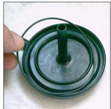
Abb. 3 - O-Ring in Gehäusedeckel einlegen
