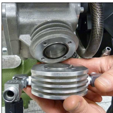
Abb. 3 - Ventilkopf mit Saug- und Druckventil entnehmen
