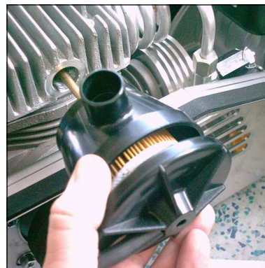
Abb. 2 - Filtergehäuse vorsichtig herausziehen
