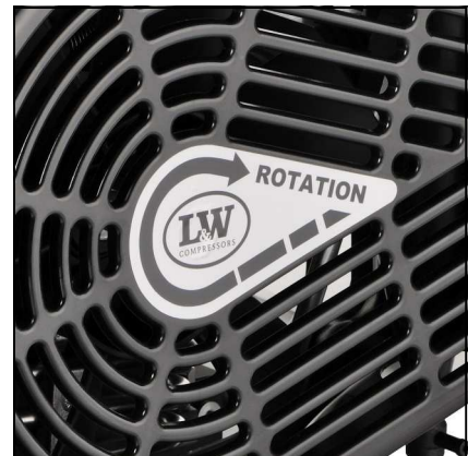
Drehrichtungspfeil auf der Ventilator-Schutzabdeckung
