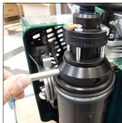
Abb. 1 - Filtergehäusedeckel mit Filterschlüssel öffnen
